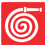
Idrante a muro
