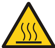
Pericolo superficie calda
