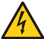
Pericolo tensione elettrica
